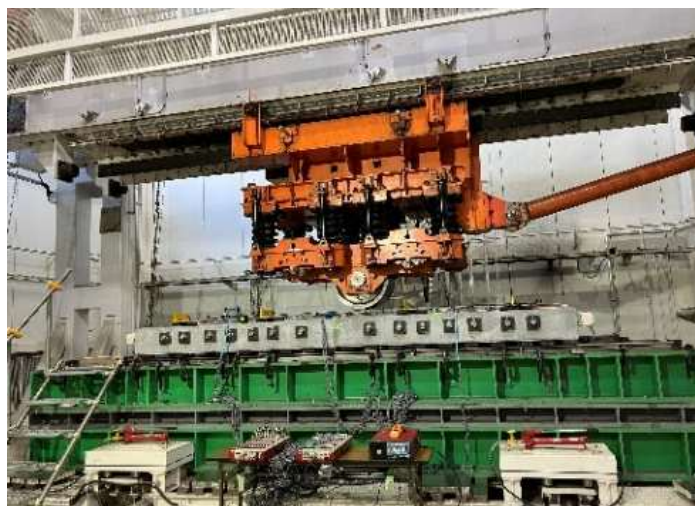
写真 1 輪荷重載荷試験状況
