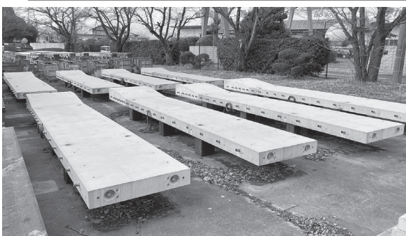
スラグ置換率70%に引き上げたPC a PC部材
