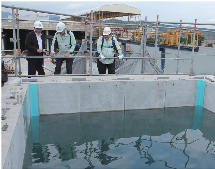
安部日鋼岐阜工場内の実験施設で角形プレキャストPCタンクの水密性・強靭性等のポテンシャルを確認
