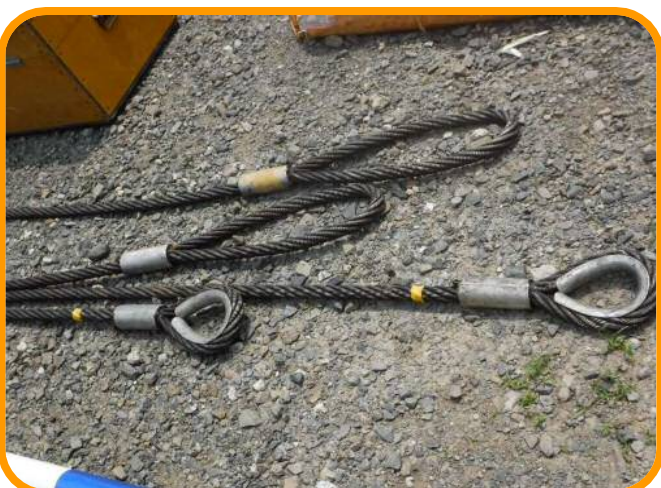
↑玉掛けワイヤーの月次点検はOKです。テープはロックの下に貼った方がよりいいですよ。
